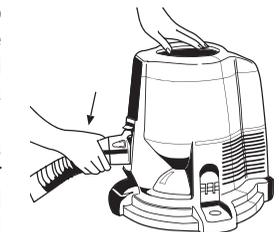
**5** Dopo aver effettuato i collegamenti elettrici, spostare l'interruttore di ACCENSIONE/SPEGNIMENTO del Rainbow sull'impostazione "alta velocità" (>>) per azionare sia il Rainbow e che Battitappeto elettrico. L'interruttore nell'impugnatura del tubo flessibile elettrificato aziona solo il Battitappeto. Per rimuovere il tubo flessibile elettrificato dall'unità inferiore, premere sui fermi laterali ed estrarre il tubo dall'apertura della presa d'aria.
