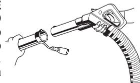
**2 ESECUZIONE DEL COLLEGAMENTO ELETTRICO:** Tenendo saldamente il tubo flessibile (non afferrare l'attuatore a interruttore su impugnatura Rainbow), inserire la spina del cavo elettrico Battitappeto nella presa sul lato inferiore dell'impugnatura Rainbow.
