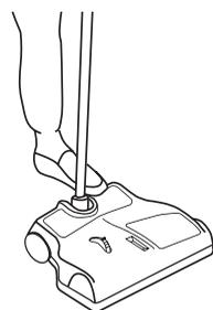
**1 COLLEGAMENTO ASTA BATTITAPPETO E IMPUGNATURA TUBO FLESSIBILE SOTTO TENSIONE:** Inserire la bacchetta corta di metallo dell'impugnatura Rainbow sul tubo flessibile sotto tensione nell'asta lunga di metallo del Battitappeto. Allineare il fermo a pulsante sull'asta corta con la guida sull'asta Battitappeto. Far scivolare il pulsante nella guida per far scattare il fermo. Quando scatta il fermo a pulsante, il collegamento è ben saldo.
